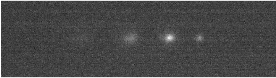
4.2. ábra. Nyers kamerakép a spektrométer felvevősíkjában (a Rowland-körön, ld. 2.13 ábra), xenon gázt alkalmazva 14 bar háttérnyomással. A három legerősebb felharmonikus (balról jobbra) H17, H19 és H21. A toroidális rács vízszintes irányban bontja fel a spektrumot, erre rakódik rá a gázjet függőleges irányú kiterjedése az ábra y tengelye mentén.
